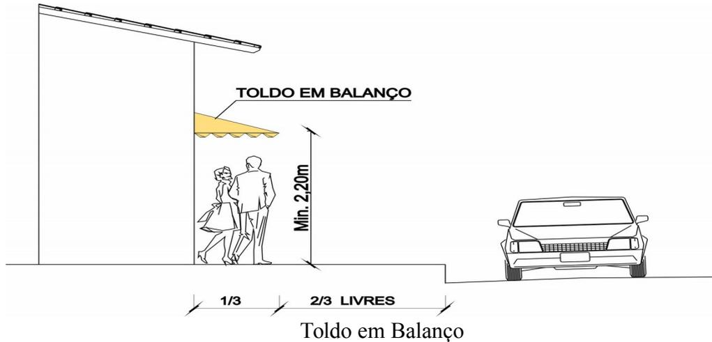
Art. 97. Toldo cortina é aquele instalado sob marquise ou laje, com projeção vertical, devendo respeitar a altura livre mínima de 2,20m (dois metros e vinte centímetros), nos termos da figura 18.
